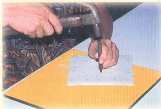
Figura 8.19. Plantilla con fotocopia para marcar las perforaciones
